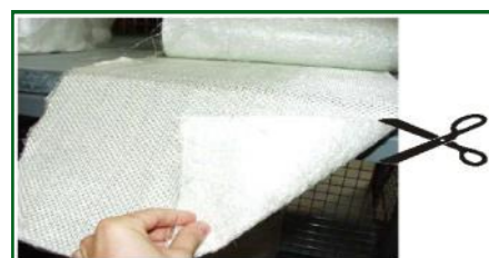
Se corta la pieza de fibra de vidrio según el tamaño del manguito
